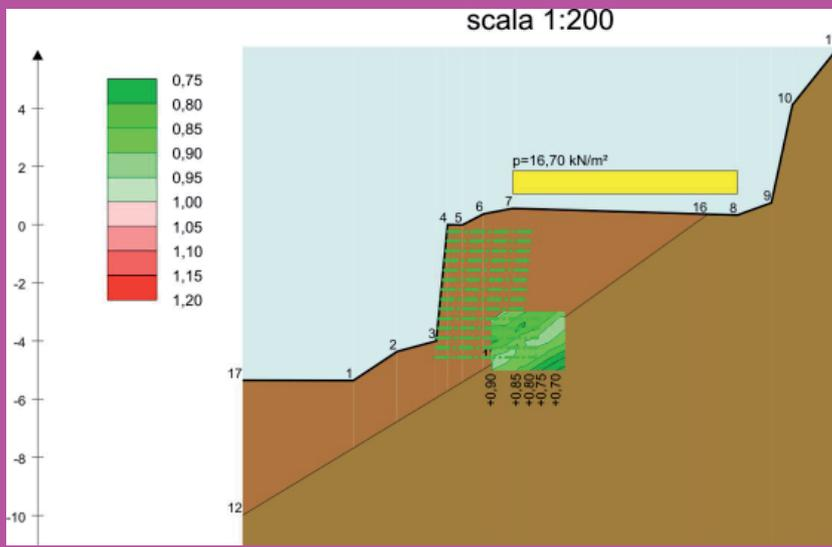
Il calcolo viene sempre effettuato caso per caso sulla scorta dei dati geometrici e geomeccanici locali. Il dimensionamento incide sulla frequenza, resistenza a trazione caratteristica e lunghezza delle geogriglie, oltre che (in misura più contenuta) sull'armatura dei manufatti di facciata.
